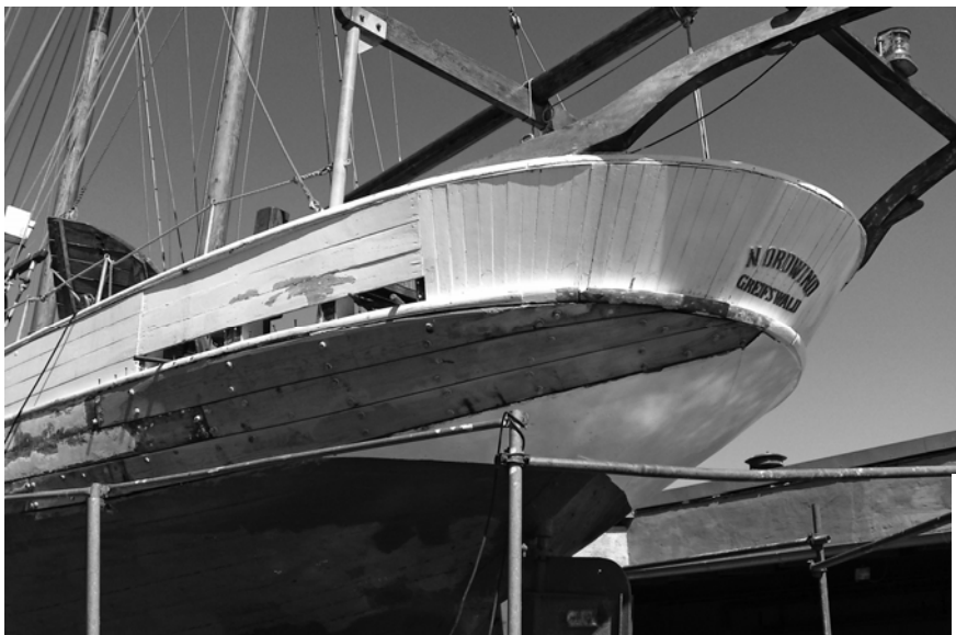
Heck des Haikutters Nordwind mit neuen Planken
