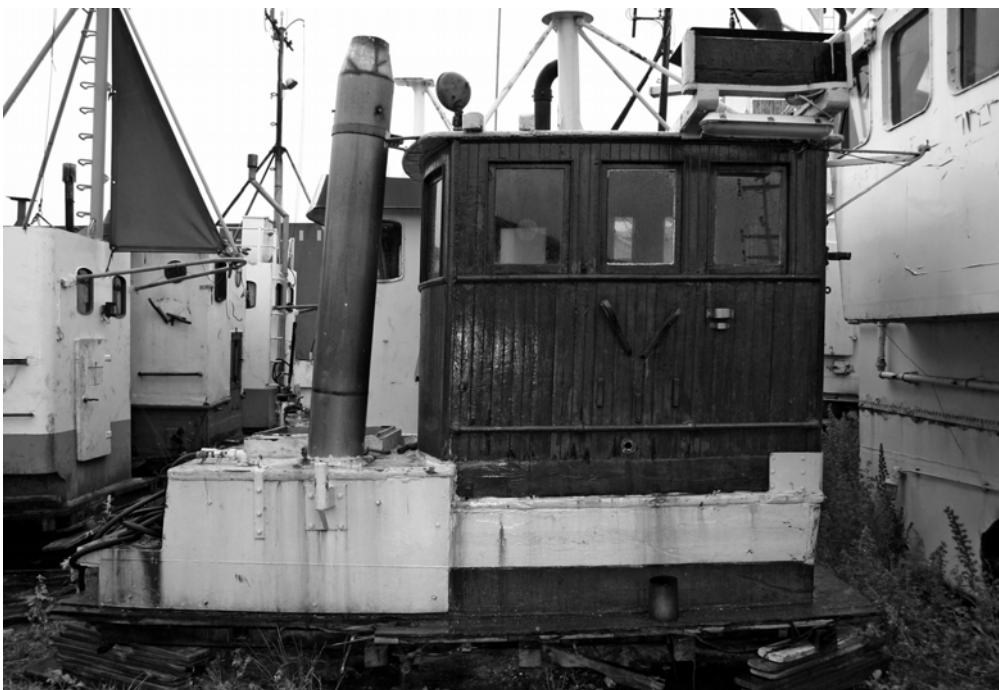
Heck des Haikutters NORDWIND mit neuen Planken
